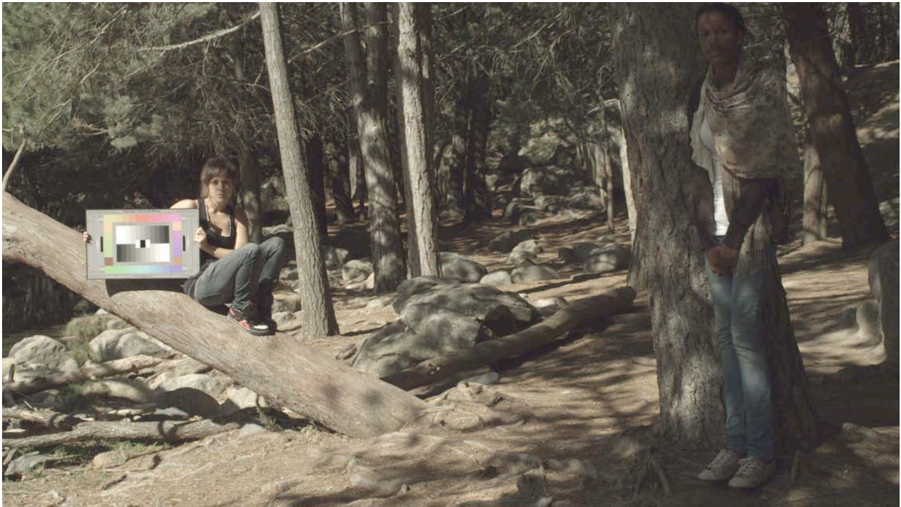
Exp. Altas Luces. Etalonado. Lente Optimo DP 30-80. F30mm T8. OBT180° MTD°K 5000. Filtro HM IR NDI.2.
