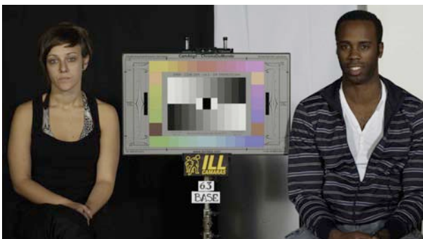
Iluminación 5000°K. (HMI corregidos).Etalonado.
