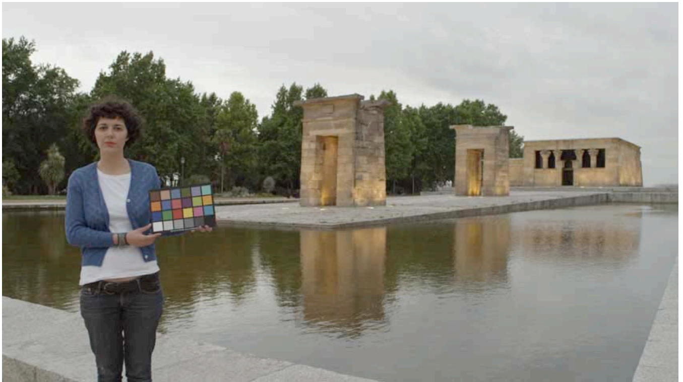
Panchro 18mm. T 5.0. MTD640. 6000°K..Obt180°.25fps. RedGamma2. Redcolor2. Fotograma Etalonado. Templo de Debod (Madrid). En esta imagen "real" podemos comprobar el efecto de la distorsión en Barril que ya observamos en las cartas.
