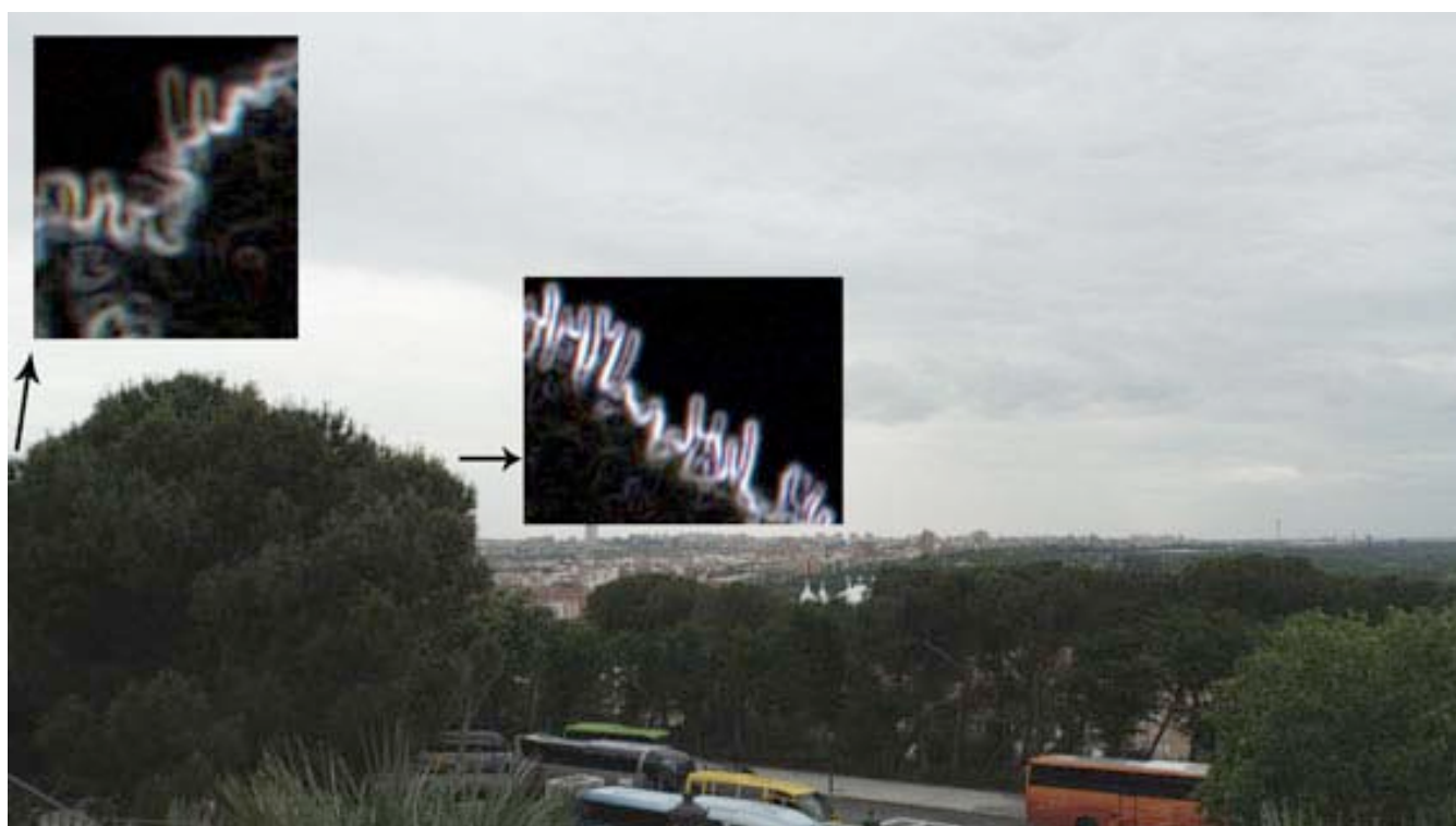
Panchro 18mm. T 7.1. MTD640. 6000°K..Obt180°25fps. RedGamma2. Redcolor2. (Madrid). El perfil de los bordes presenta no solo menos nitidez sino también menor luminosidad.
