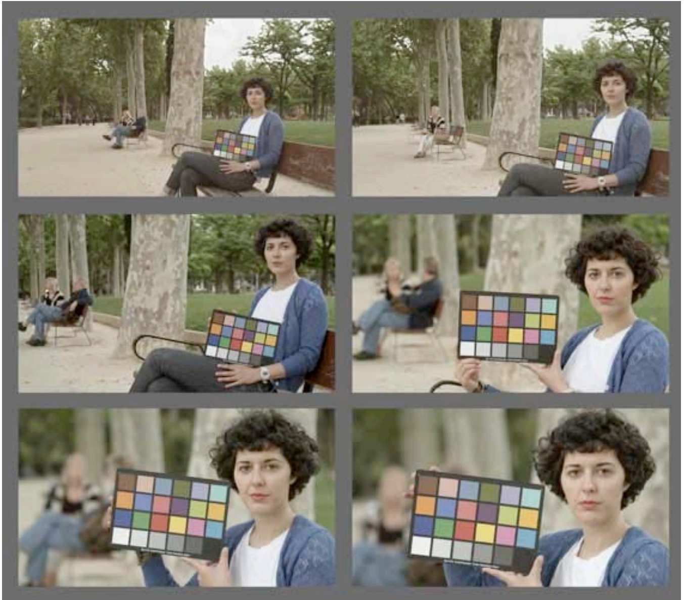
Una vista de todas las lentes. De izquierda a derecha y de arriba abajo: Panchro 18mm. T 6.3 Panchro 25mm. T 6.3 Panchro 32mm. T 3.3. Panchro 50mm. T 2.8 Panchro 75mm. T 2.8 Panchro 100mm. T 2.8. Todos con MTD640. 6000°K..Obt180°.25fps. RedGamma2. Redcolor2. Fotograma Etalonados.
