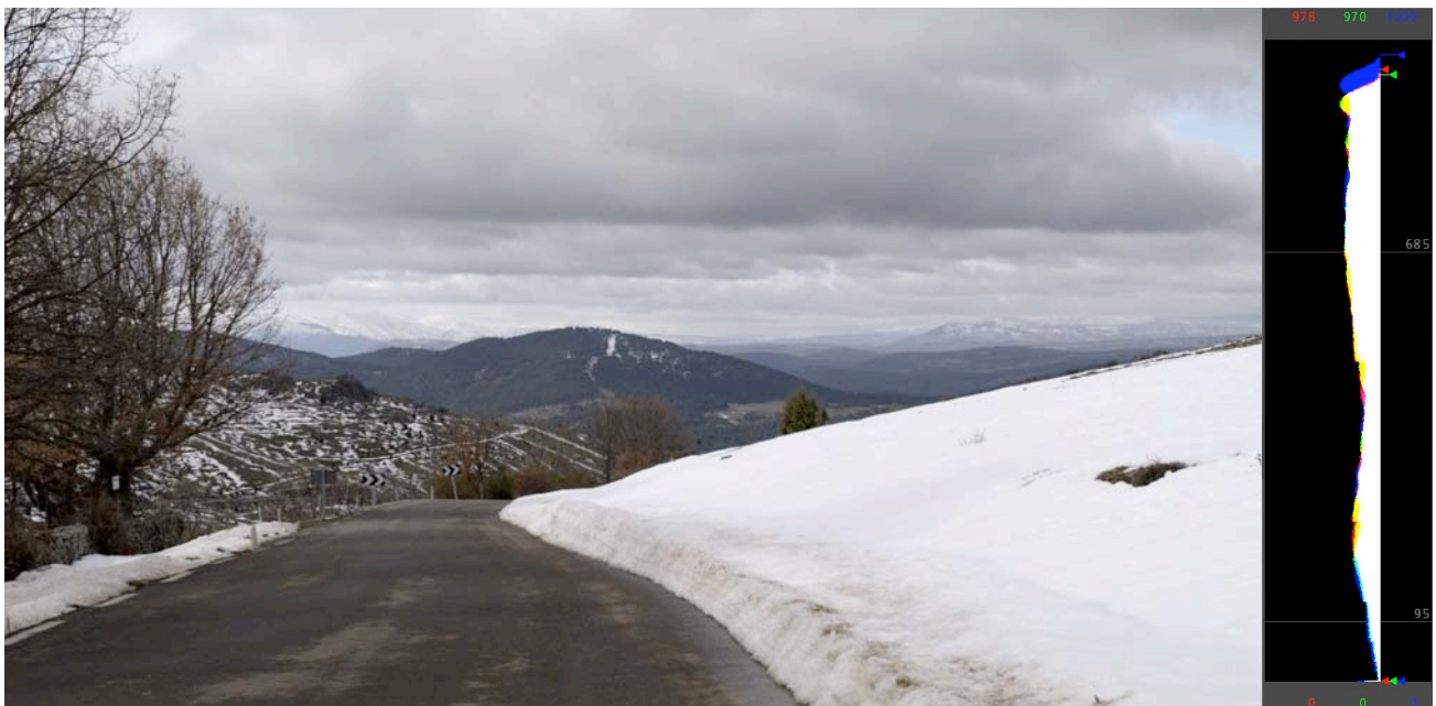
Fotograma etalonado con Iridas. Curva Slog RD extended Preset 5.600°K F40mm T 10 Filtro: Pola+ND1.2.
