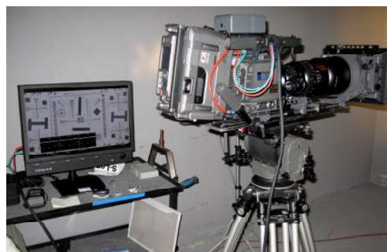
Evaluación de la resolución en la sala de pruebas de INFOTV. Se puede observar la carta ISO en el monitor Cinetal.
