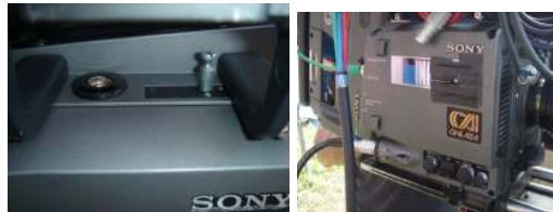
Pivote para marcar el plano focal y "apaño" en la parte derecha de la cámara para sujetar el decámetro.
