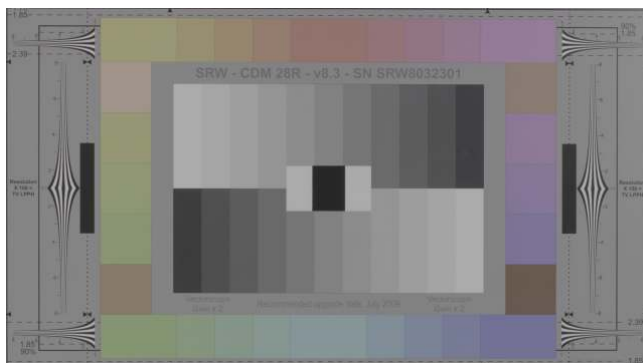
Obsérvese en esta carta con la curva S-log, la menor luminosidad de los grises medios y las altas luces. Nota: los valores en el monitor de ondas están en %
