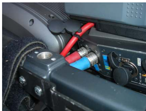
El asa en L entorpece la conexión Dual Link
